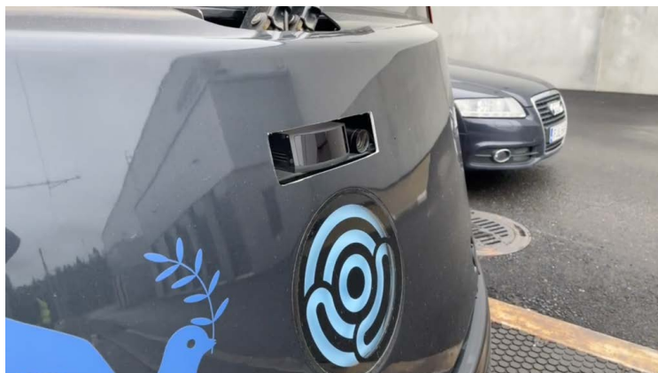
Obr. 2.21 - Umístění LiDARu v čele tramvaje výrobce Škoda Group [35]
