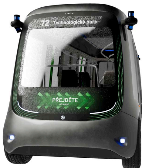
Obr. 6.24 - Alternativní verze senzorů umístěných v A-sloupcích
