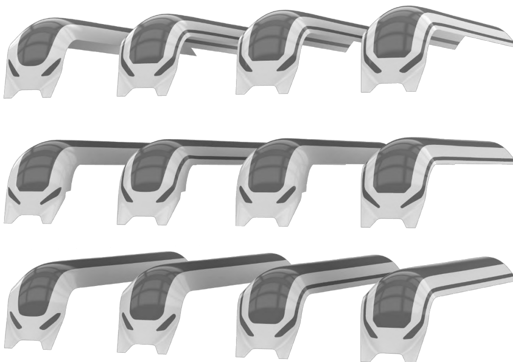
Obrázek 5-4 Vybrané kombinace světel a čelního skla
