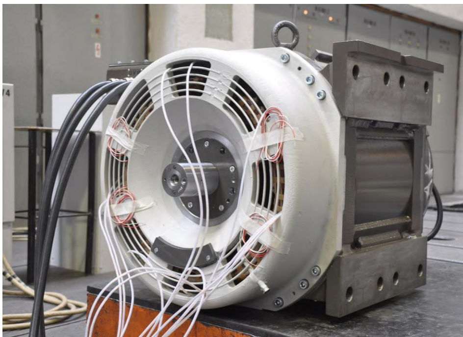
Obrázek 2-38 Motor Škoda ML 3942 [67]
