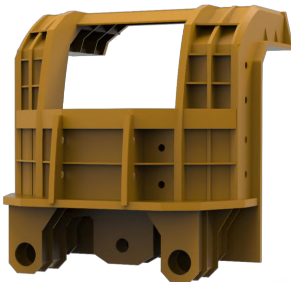
Obrázek 6-14 Bezpečnostní kostra kabiny
