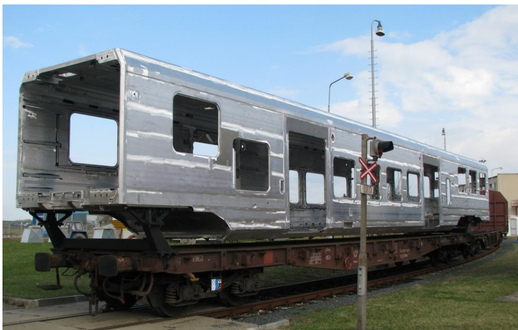
Obrázek 2-27 Hliníková skříň RegioPanteru [60]
