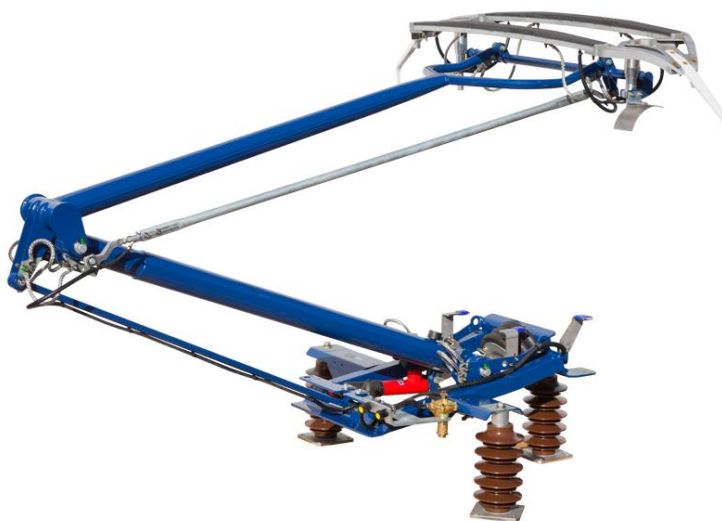
Obrázek 2-36 Pantograf od Faiveley Transport [65]
