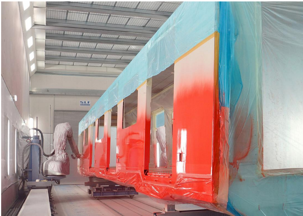
Obrázek 2-42 Automatické lakovací centrum [42]
