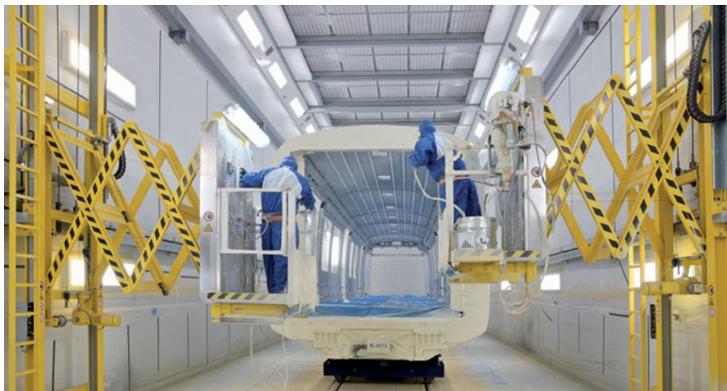
Obrázek 2-41 Manuální lakovací centrum [42]
