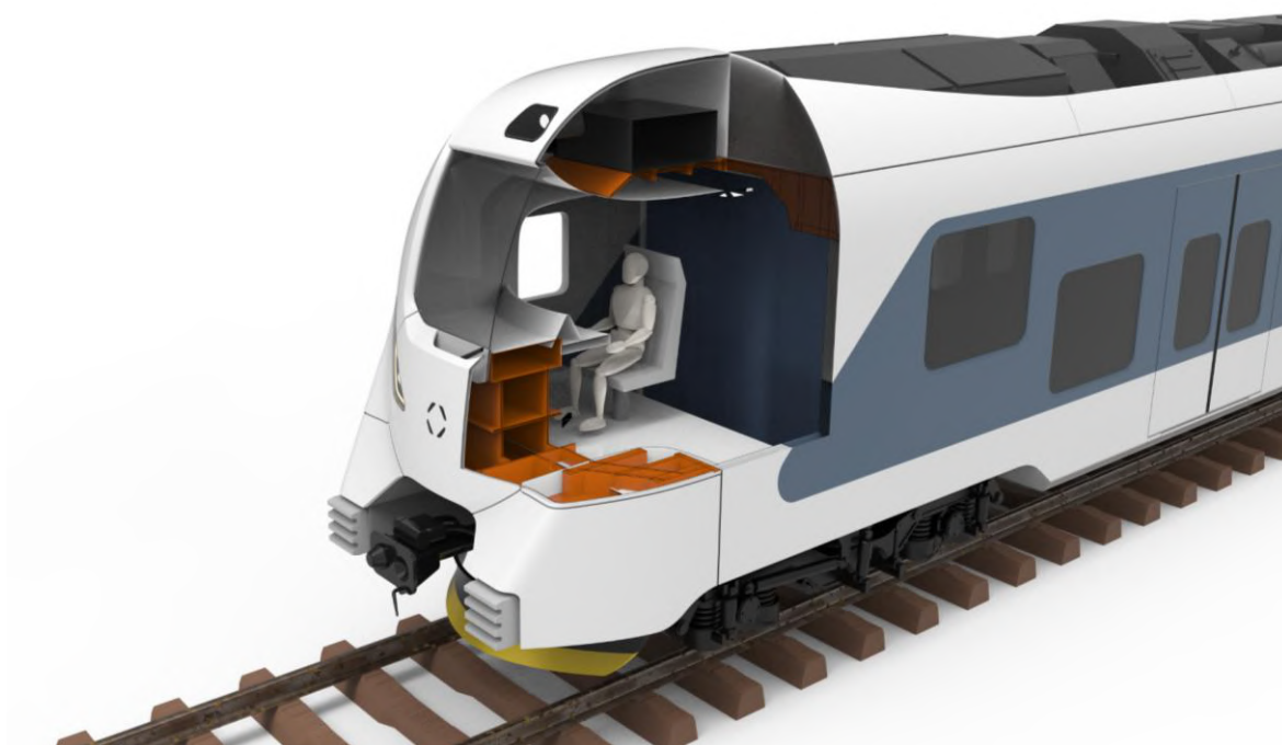
Obrázek 6-26 Rozložení kabiny strojvedoucího
