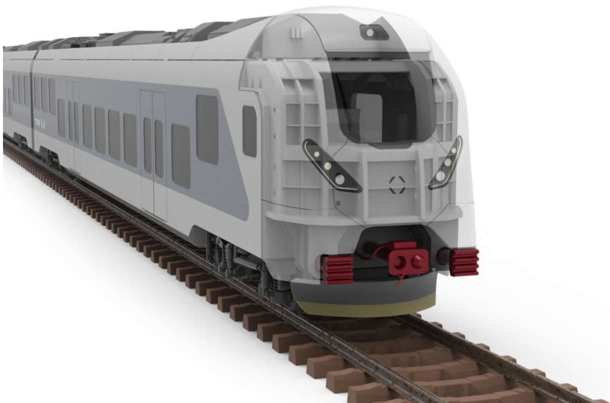
Obrázek 6-18 Spřáhlo a anticlimbery
