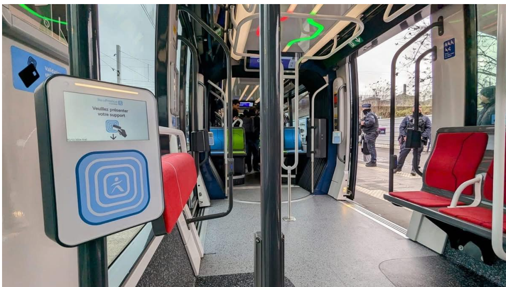
Fig. 2- 27 Interior of Alstom Citadis TW20 Paris [28]
