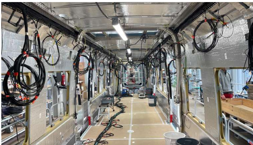
Obr. 2-22 Elektroinstalace kolejového vozu [21]
