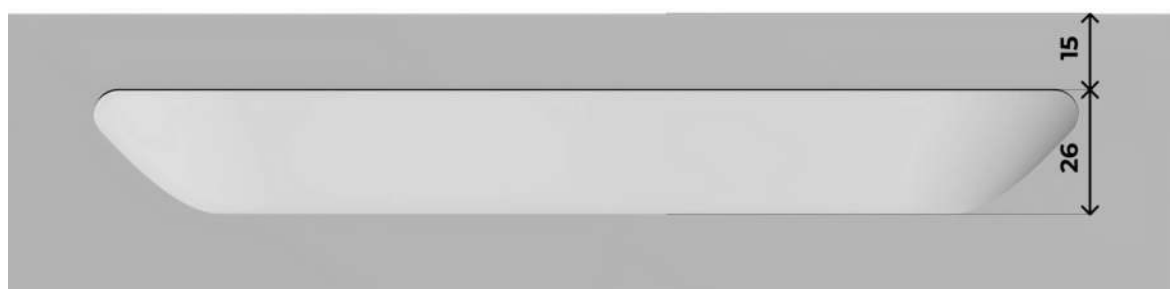
Obr. 6-45 Madlo víko boxu řez
