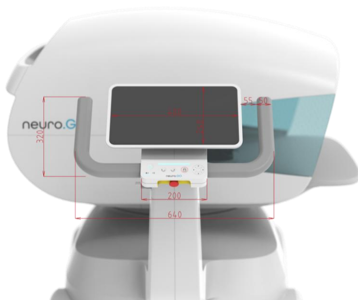
Obr. 6-21 Rozměrové řešení řídících model a displeje
