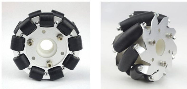
Obr. 2-25 Holonmická kola – Omni wheel (vlevo), Mecanum wheel (vpravo) [42]
