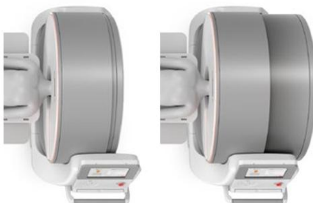
Obr. 2-7 Teleskopický mechanismus, vlevo – počáteční pozice skeneru, vpravo – konečná poloha skeneru [11]
