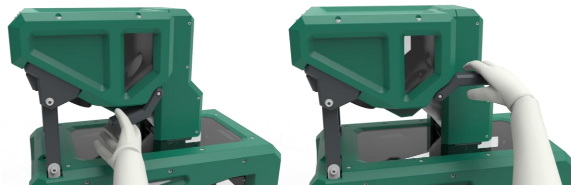
Obr. 6-14 Ovládání klapky pomocí páčky – vlevo otevřený stav, vpravo zavřený stav
