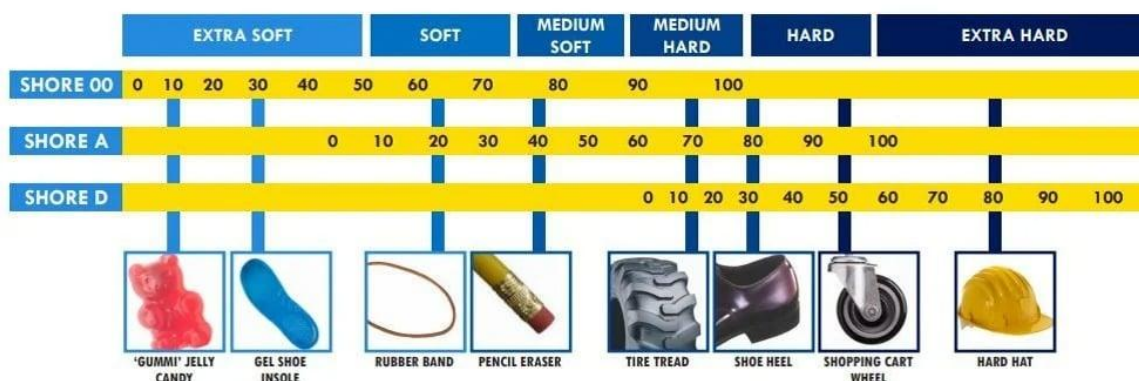
Obr. 2-22 Stupnice tvrdosti Shore u měkkých polymerů, dostupné z [90]
