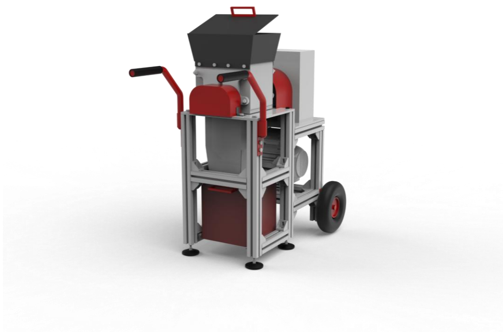
Obr. 6-58 Finální koncepční řešení drtiče, pohled zleva
