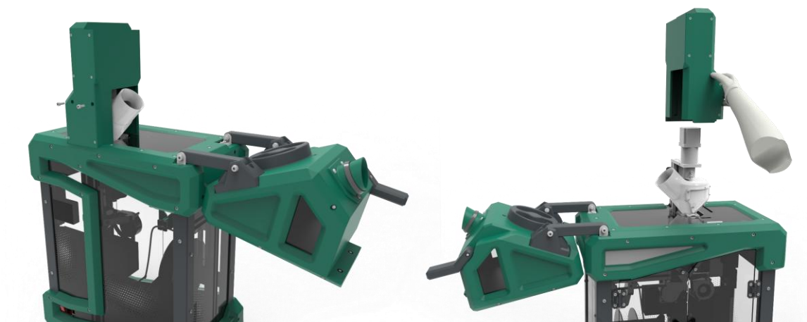
Obr. 6-20 Způsob snímání (vertikální vysunutí) krytu mísící komory
