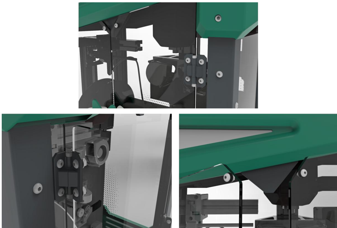
Obr. 6-23 Detail magnetických dorazů a pantů s dorazy definující maximální výklop
