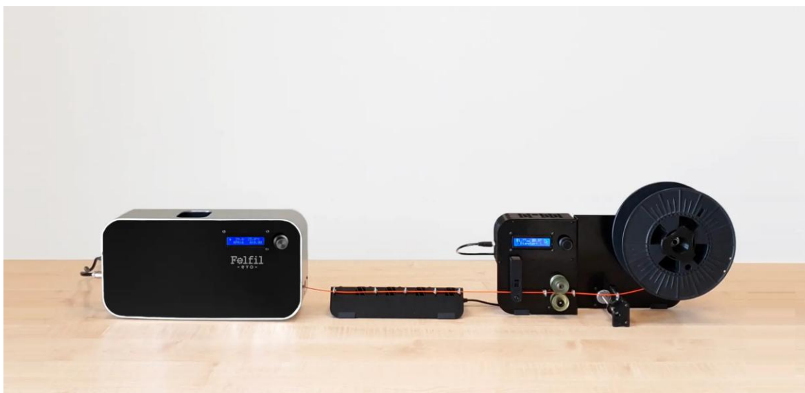
Obr. 2-14 Felfil Evo & Spooler (kompletní sestava vč. kluzného modulu), dostupné z [26]
