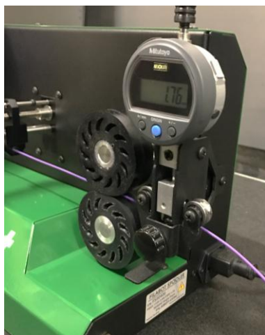
Obr. 2-12 Digitální senzor tloušťky filamentu, dostupné z [78]
