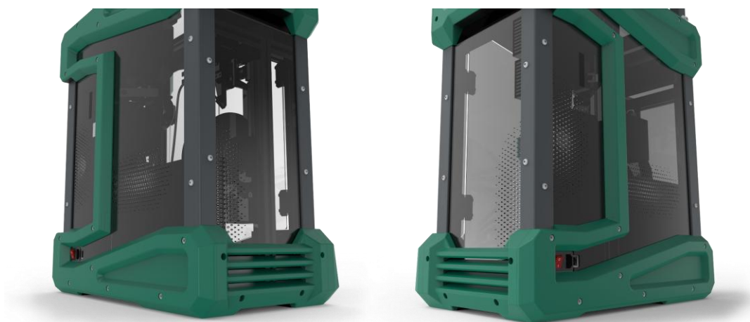
Obr. 6-37 Detailní pohled na perforovaná místa krytu (výdechy) a spodní ventilační mřížky (vstup vzduchu)
