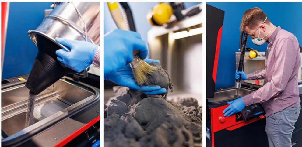
Obr. 2-8 Fáze tisku na SLS tiskárně – plnění přístroje práškem; post-processing; čištění přístroje, dostupné z [13]
