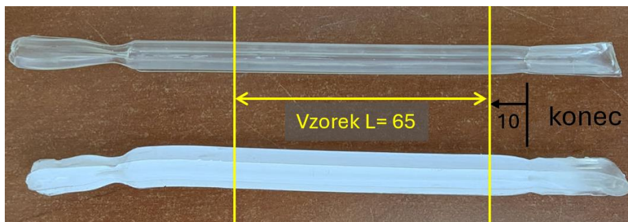
Obr. 4-26 Nahoře vzorek křížového průřezu (se stopami po titanovém nástřiku), dole vzorek tvaru hvězda s titanovým nástřikem
