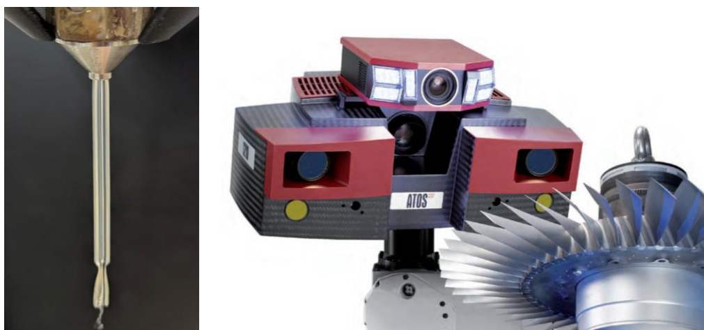
Obr. 4-25 Vlevo volná extruze vzorku, vpravo Atos TripleScan [76]
