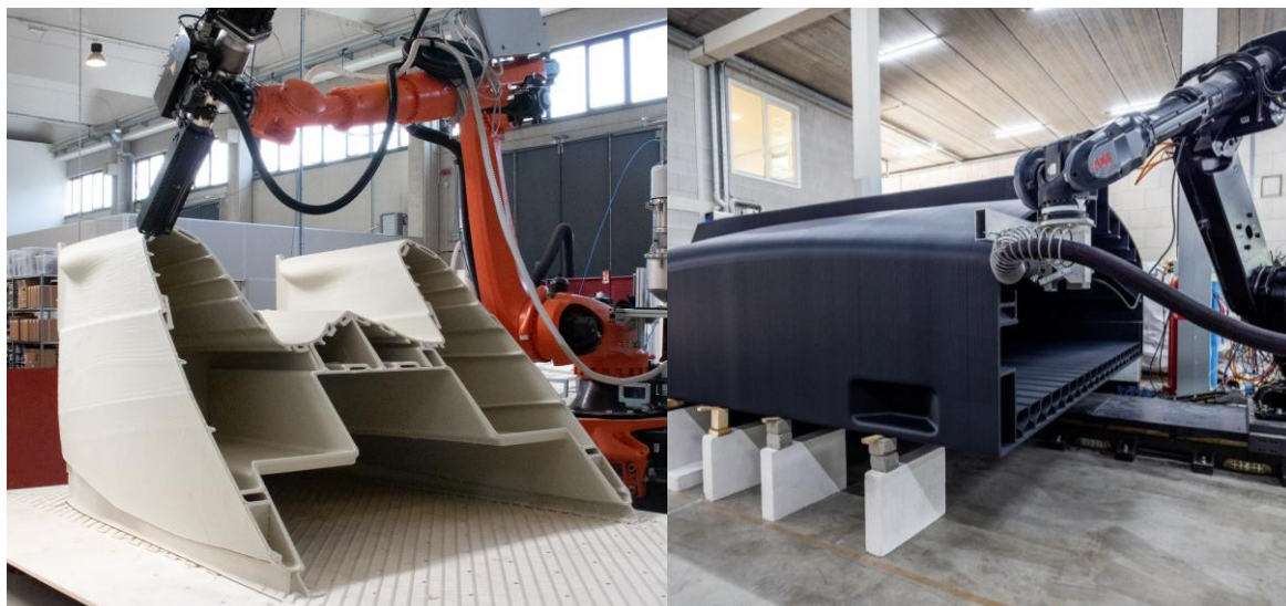
Obr. 2-11 Robotický tisk lodí, vlevo pod úhlem 45° [21], vpravo vertikálně [22]
