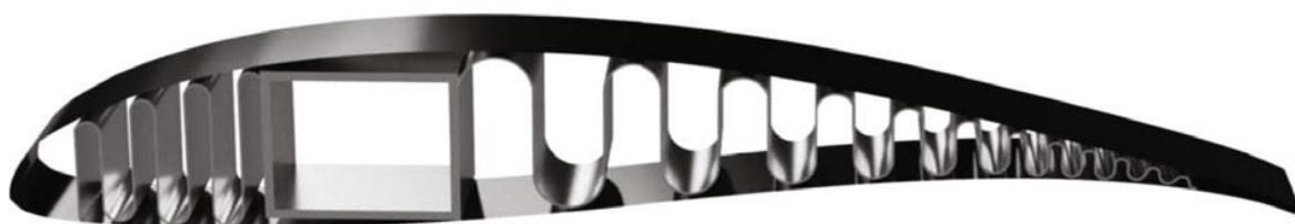
Obr. 2-3 Koncept monolitickej štruktúry s vlnitým periodickým rebrom[7]
