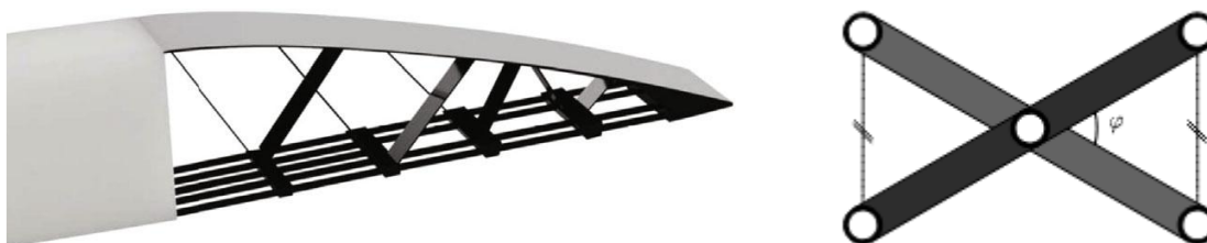
Obr. 2-5 Vľavo - Koncept štruktúry s viacerými stupňami voľnosti [7], vpravo Nožnicový prvok mechanizmu odtokovej hrany [7]
