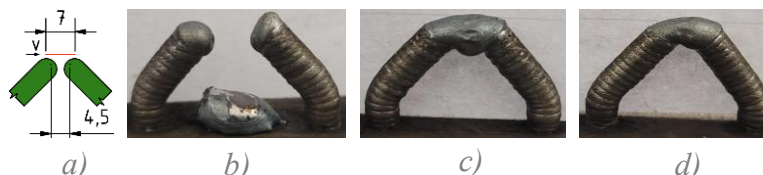
Obr. 5-35 Nastavení rychlosti kontinuálního uzlu FCC a) Trajektorie výroby kontinuální vrstvy, b) Rychlost 0,003m/s, c) 0,005m/s, d) 0,008
