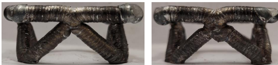
Obr. 5-42 Deformace buňky FCC – Přiblížení prutů (vlevo), Kontinuální navaření (vpravo)
