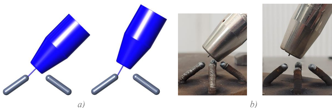
Obr. 5-20 Vyhnutí se kolizi a) Simulace v programu, b) Test při výrobě
