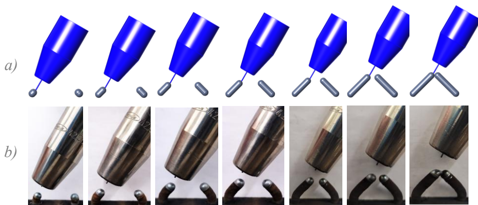
Obr. 5-38 Analýza kolize plošného uzlu FCC buňky a) Simulace, b) Výroba
