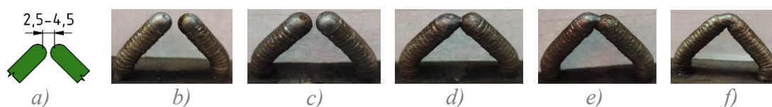
Obr. 5-34 Nastavení šířky uzlu FCC, a) Schéma uzlu, b) Šířka 4,5mm, c) 4mm, d) 3,5mm, e) 3mm, f) 2,5mm
