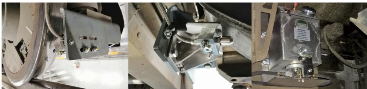
Obr. 2-11 Igralub TrainSys-AL: Umístění jednotky na podvozku [18]
