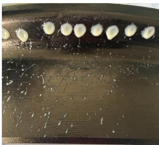
Obr. 5-20 Příklad méně kvalitního nástřiku, kde dochází k odrážení maziva (Tryska 4, 40 °C, dávka 5)
