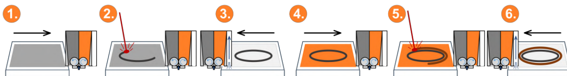
Obrázek 2-20 Princip holohedral nanášení: 1) Nanesení materiálu A, 2) Vypálení geometrie materiálu A, 3) Odsátí přebytečného materiálu A, 4) Nanesení materiálu B, 5) Vypálení geometrie materiálu B, 6) Odsátí přebytečného materiálu B
