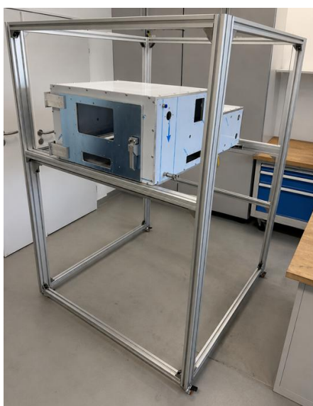
Obrázek 6-26 Ustavení zbývajících stěn komory
