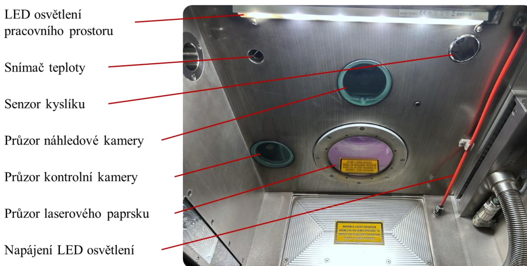
Obrázek 2-43 Sensorická soustava na stropnici zařízení SLM280 HL
