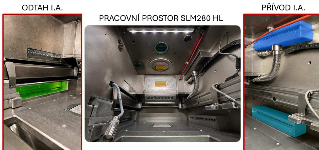
Obrázek 2-27 Pracovní prostor SLM280 HL se zvýrazněnými distributory
