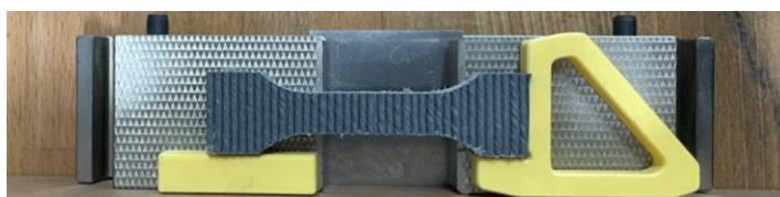
Obr. 4-36 Použití magnetických středících přípravků společně s vyrobenými čelistmi
