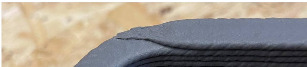
Obr. 4-38 Detail na řízené oddělení taveniny od výtisku vpravo
