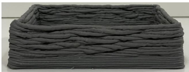
Obr. 4-19 Defekt výtisku způsobený akumulací tepla při krátkém čase vrstvy
