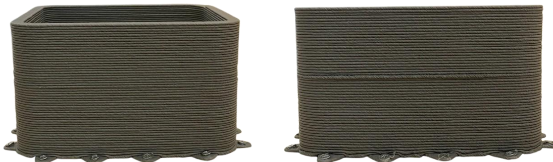
Obr. 6-5 Rozdílná povrchová návaznost segmentového spoje při shodném koeficientu přeextruze
