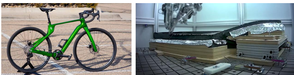
Obr. 2-9 Superstrata 3D tištěné elektrokolo [21] Proces tisku rámu jízdního kola [22]
