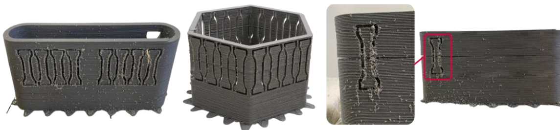
Obr. 5-8 Vybraná tělesa screeningových experimentů vlevo, deformace podlouhlého tělesa vpravo
