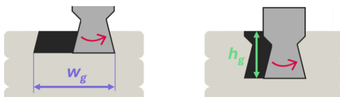
Obr. 4-27 Schéma změny šířky obráběné drážky při použití jednoho nástroje
