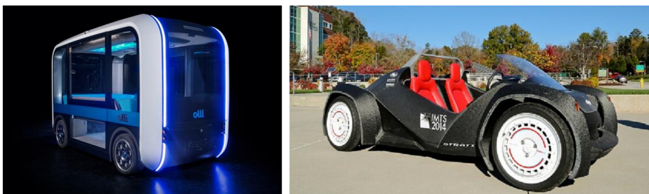
Obr. 2-7 Olli 2.0 plně autonomní 3D tištěný automobil [17], Strati první 3D tištěný automobil [18]
