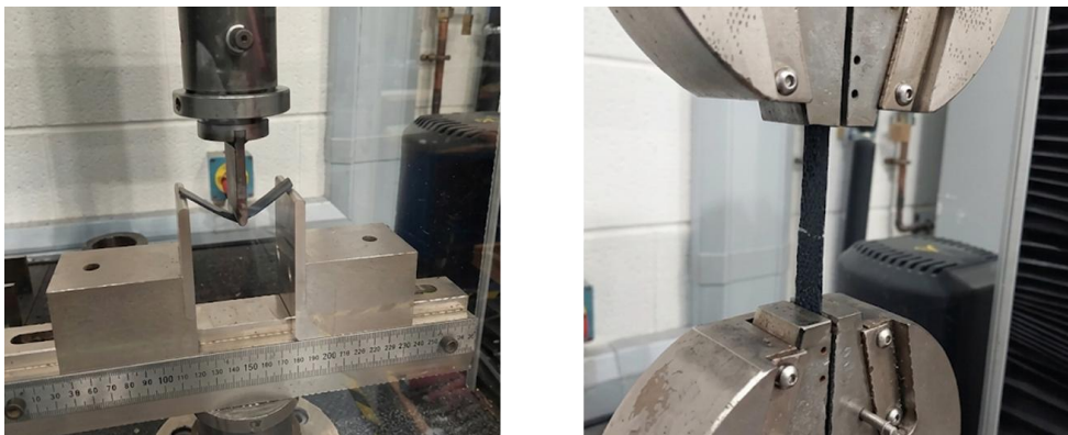
Obr. 2-29 Testování mechanických vlastností vzorků LFAM, zkouška v ohybu vlevo, zkouška v tahu vpravo
