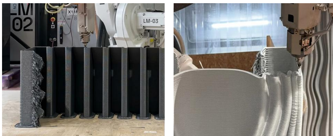
Obr. 2-4 Defekty způsobené omezenou retrakcí [11]
