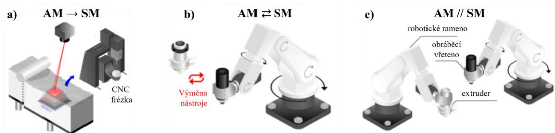
Obr. 2-3 Konfigurace výrobních platform HASM
