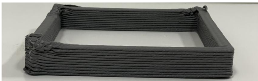
Obr. 4-21 Defekt vzniklý v důsledku akumulace materiálu v ostrém rohu výtisku
