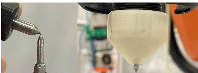
Obr. 4-28 Kalibrace obráběcího vřetene vlevo, kalibrační tryska extruderu vpravo
