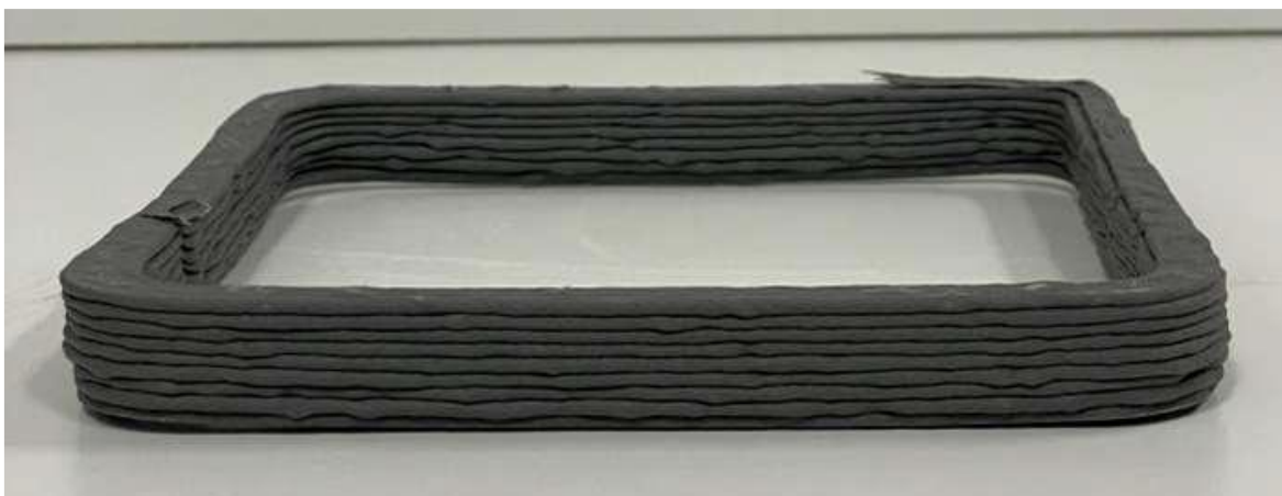
Obr. 5-1 Neprotavený materiál při překročení procesního okna extruderu
