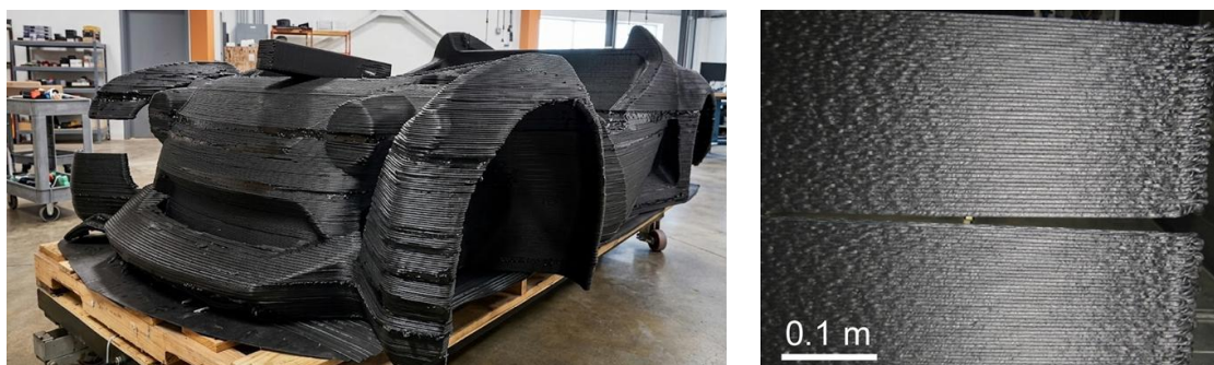
Obr. 2-27 Výtisk karoserie automobilu s rozsáhlými deformacemi vlevo, mezivrstvá delaminace vpravo
