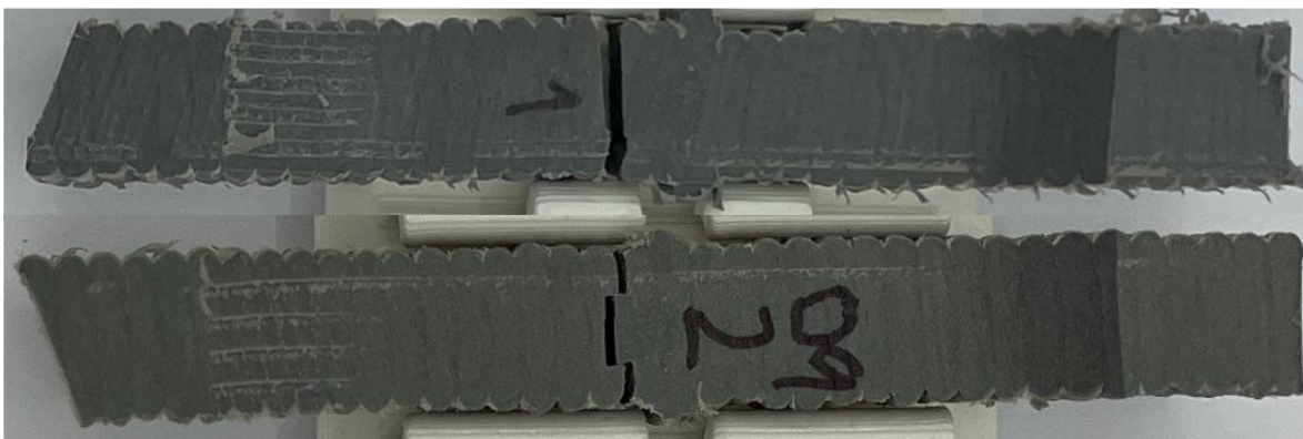
Obr. 5-14 Mechanismus porušení spoje charakteru křehkého lomu
