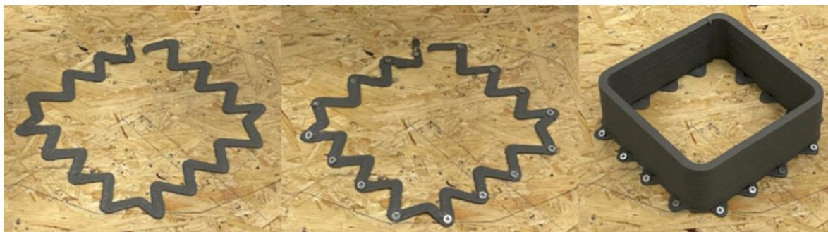
Obr. 4-31 Kroky použití technologického raftu pro upevnění výtisku na podložce
