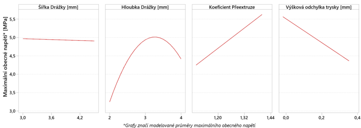
Obr. 5-18 Graf hlavních efektů rozšířeného modelu se zahrnutím výškové odchylky trysky vůči drážce
