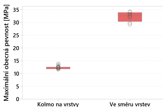
Obr. 5-3 Krabicový graf naměřené pevnosti u kontinuálně tištěných výtisků
