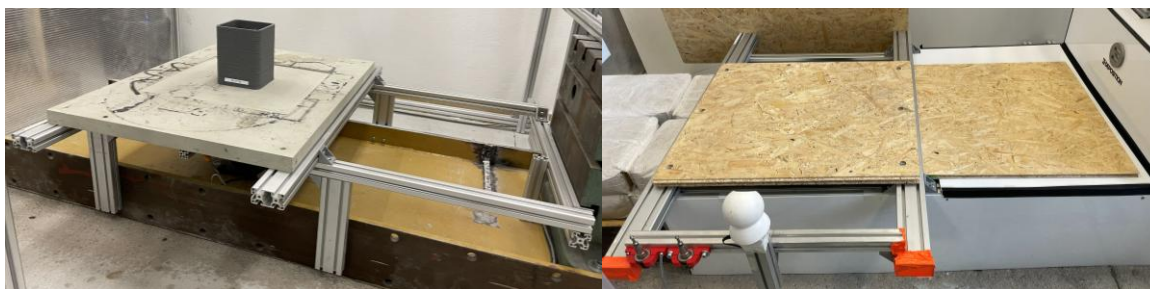
Obr. 4-7 Nově realizovaná modulární tisková platforma v nekrytované i krytované konfiguraci
