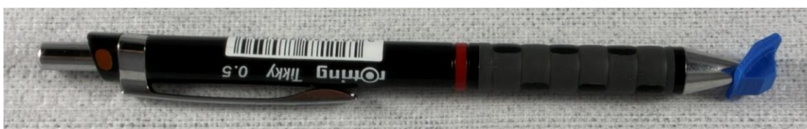
Obr. 4-18: Mikrotužka s přípravkem pro správné provedení testu studujícího vnitřní útlum na 4-ball konfiguraci
