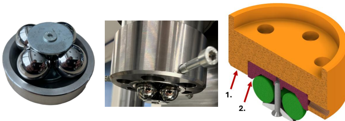
Obr. 4-10: Vlevo) Miska s kuličkami, Uprostřed) Horní část konfigurace, Vpravo) CAD model horní části konfigurace
