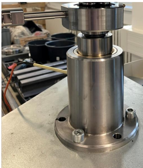
Obr. 4-7: Vlevo) Implementovaná konstrukce spodní části konfigurace, Vpravo) CAD model sestavy spodní části konfigurace s popisky
