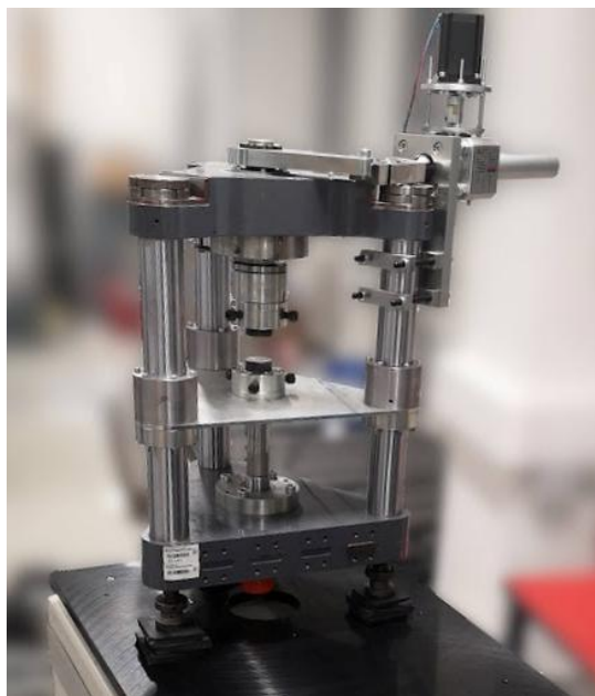
Obr. 2-12: Původní stav modulárního rotačního tribometru s axiálním zatěžováním
