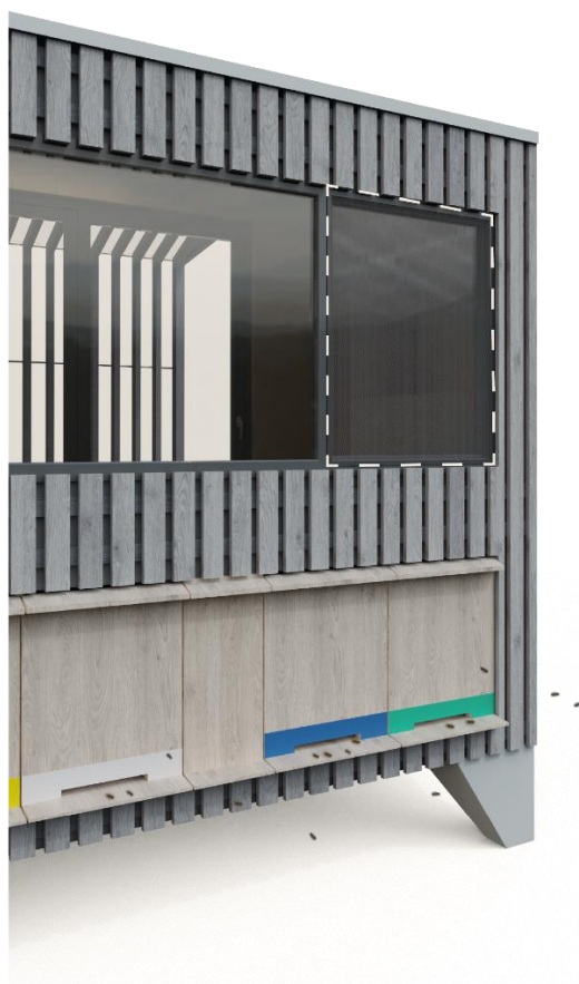
Obr. 6-32 Okno opatřené sítí proti hmyzu
