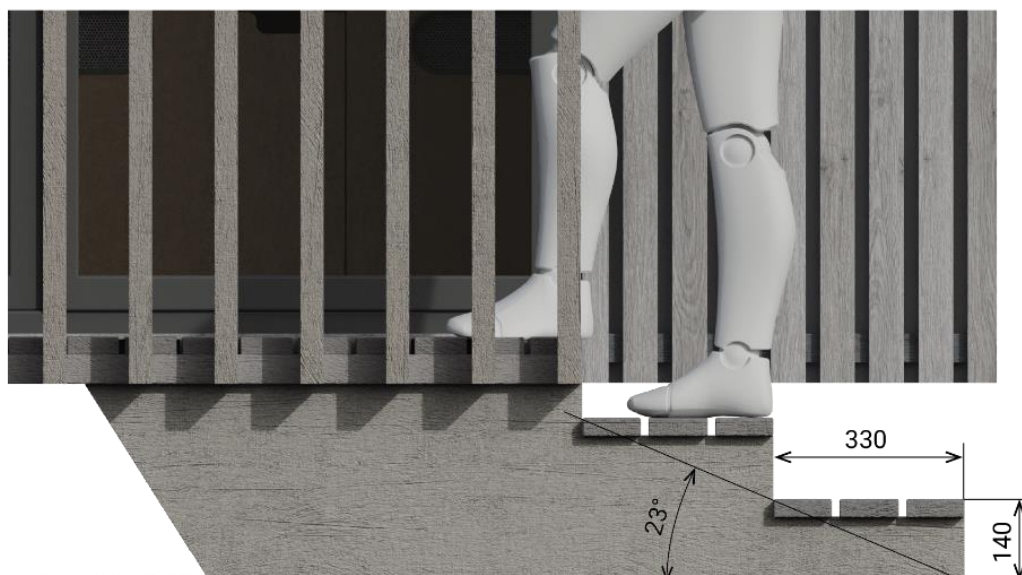
Obr. 6-22 Schodiště na terasu
