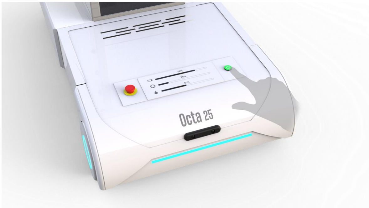
Obr. 6-52 Ergonomické řešení – tlačítko pro zapnutí/vypnutí
