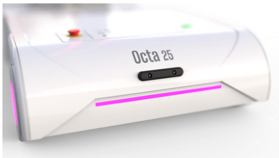
Obr. 6-30 Umístění Lidaru v přední části
