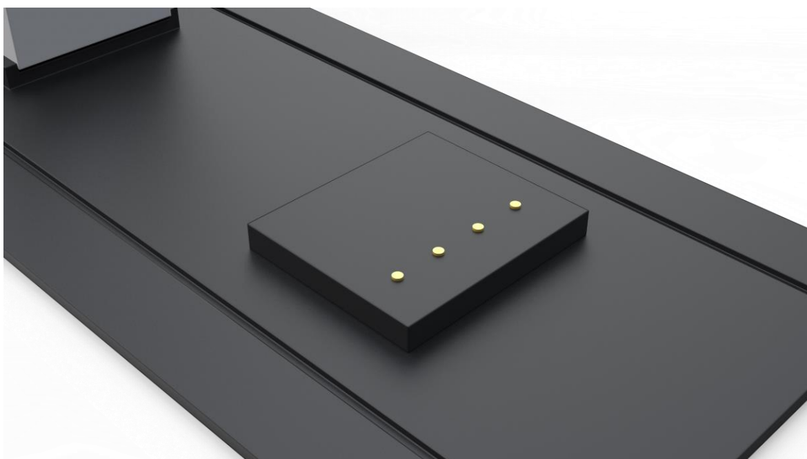
Obr. 6-36 Piny pro dobíjení robota ve spodní část
