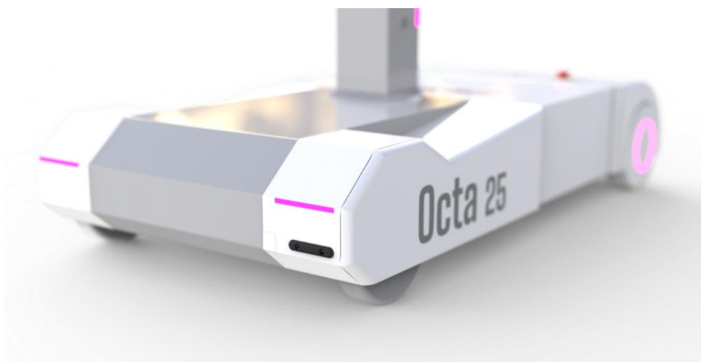
Obr. 6-31 Umístění Lidaru v zadní části
