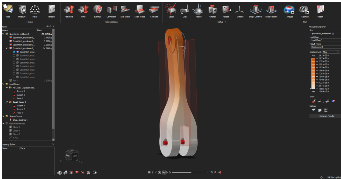
Obr. 6-29 Proces návrhu v programu Altair Inspire, zatížení a analýza
