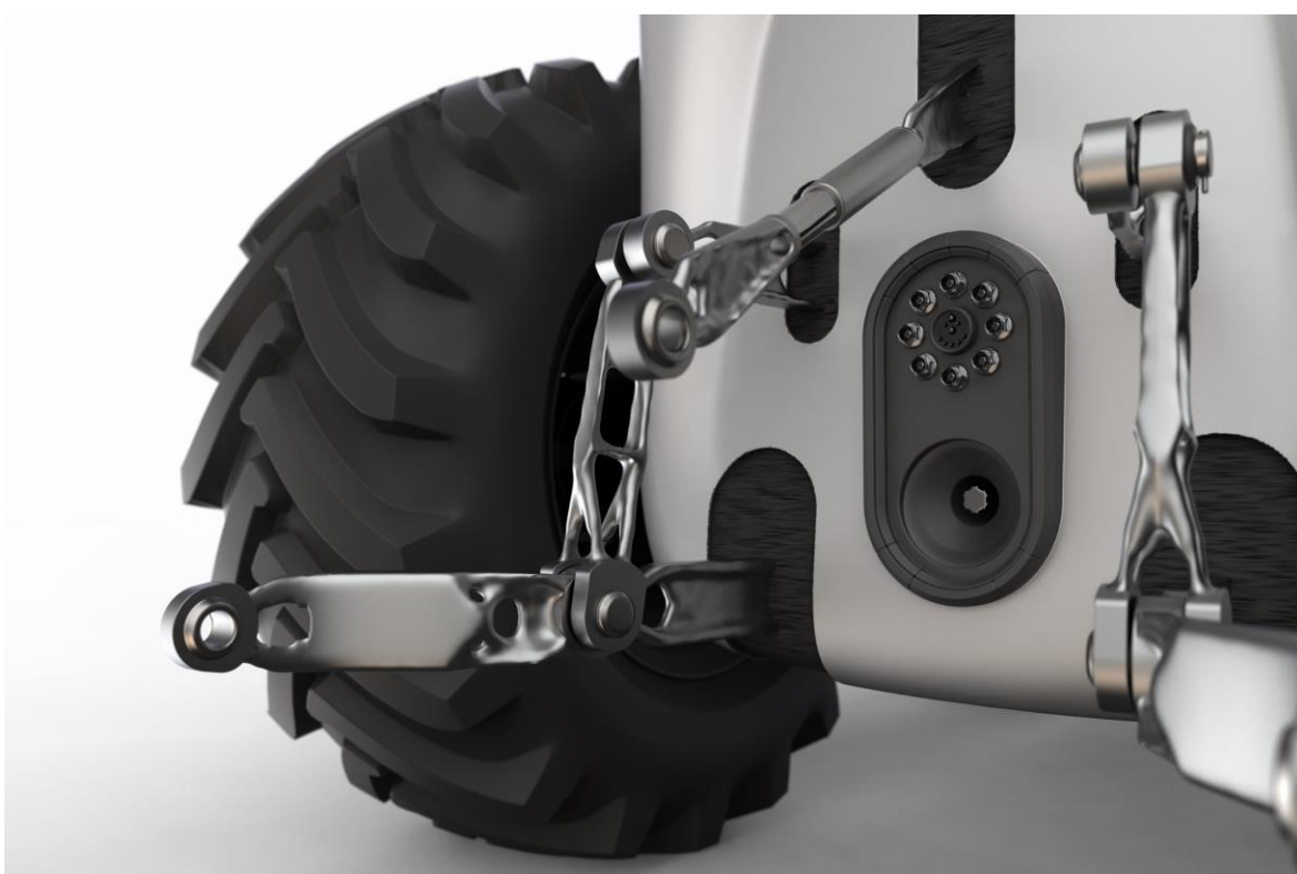
Obr. 6-18 Detailní pohled na zadní tříbodový závěs, PTO, hydraulické a elektrické přípojky
