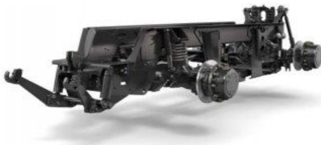
Obr. 2-45 Rámová konstrukce podvozku Fastrac [52]
