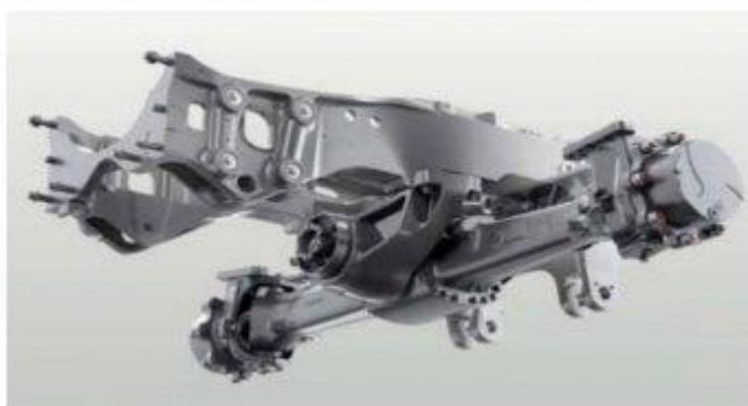
Obr. 2-46 Polorámová konstrukce podvozku Fendt [52]
