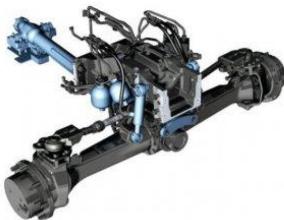
Obr. 2-48 Hydropneumatické odpružení přední nápravy [52]
