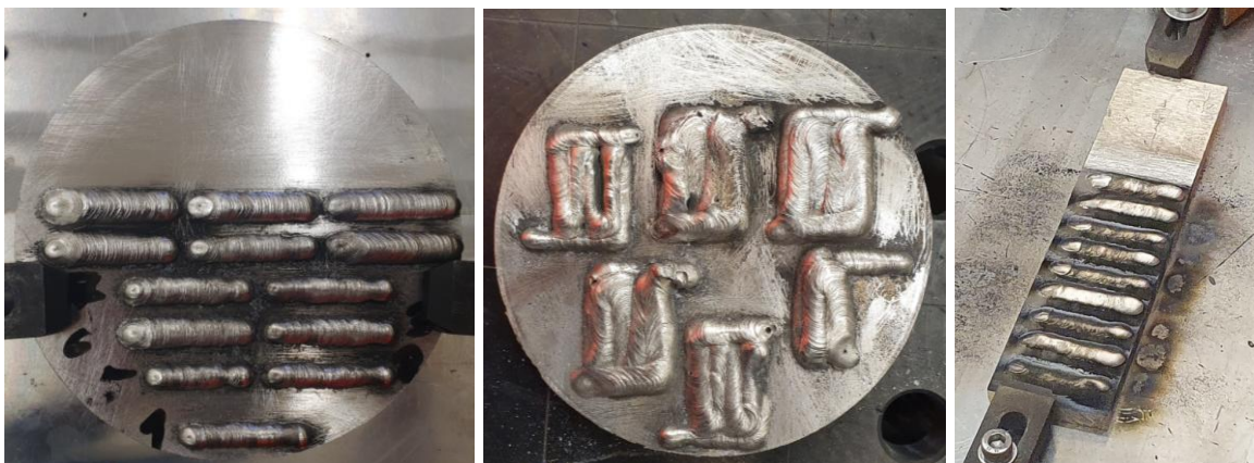
Obr. 5-1 a) Jednoduché návary, b) 2D trajektorie, c) Návary pro analýzu provaření
