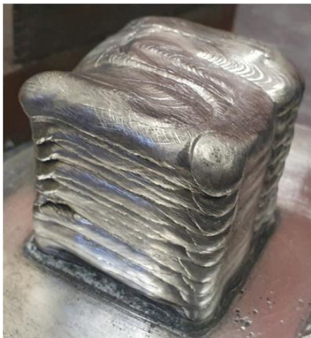
Obr. 5-24 a) Objemový díl vyrobený střídavou trajektorií S-pattern, b) Porovnání s předpokládanou geometrií
