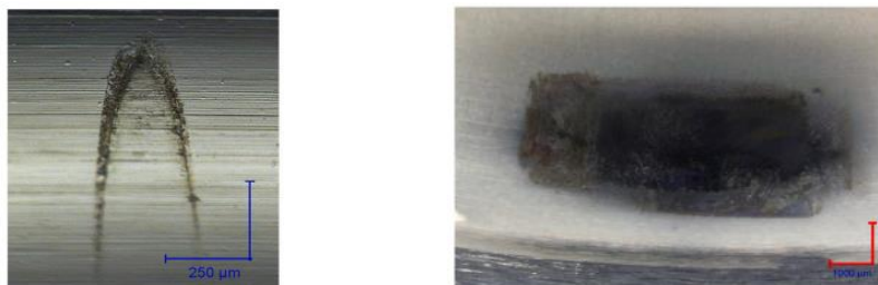
Obr. 2-15 vzniklé poškození (vlevo false brinelling, vpravo třecí koroze) [29]
