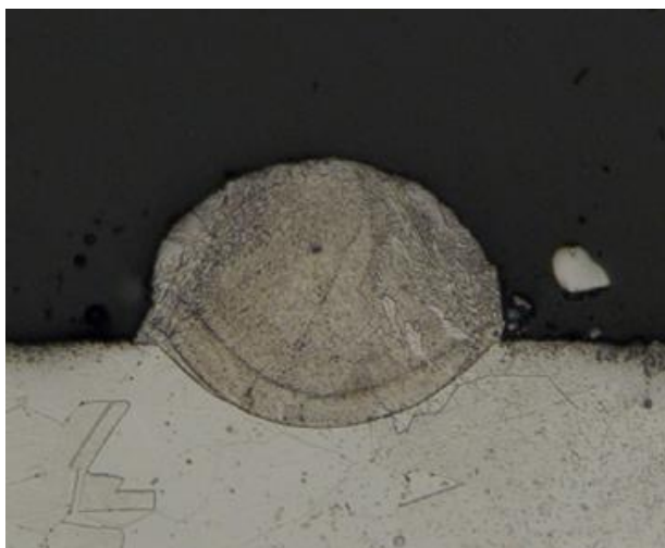
Obr. 2-29 Tvar návaru v kondukčním režimu [44]
