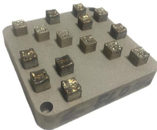
Obr. 5-17 Vyrobené vzorky pro LT 100 \mu\text{m}
