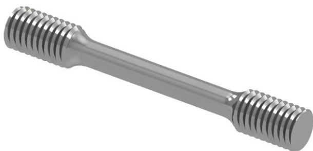
Obr. 4-9 Tahový vzorek DIN 50125 typ B
