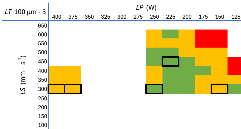
Obr. 5-14 Hodnocení třetího experimentu pro LT\ 100\ \mu\text{m}
