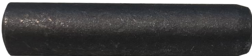
Obr. 6-17 Kolík \varnothing 6–28 mm se značnými povrchovými vadami způsobenými kolizemi mezi jednotlivými součástmi a nezaschlým povlakem.
