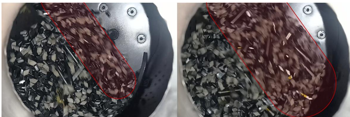
Obr. 6-19 Velikost kaskádové vrstvy pro úroveň plnění 1,7 % (vlevo) a 4,2 % (vpravo).
