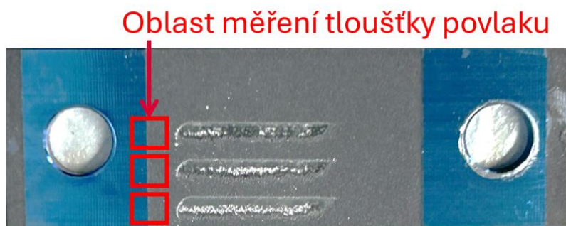
Obr. 5-4 vzorek po vykonání testu s vyznačenými oblastmi měření tloušťky povlaku.
