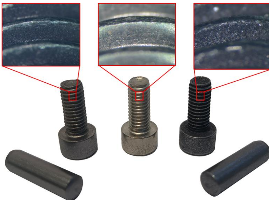
Obr. 6-12 Porovnání výsledného povrchu povlaku aplikovaného na šrouby M5-20: a) pro průtokový objem odsávání 470 m 3 /h, b) bez povlaku, c) pro průtokový objem odsávání 390 m 3 /h,
