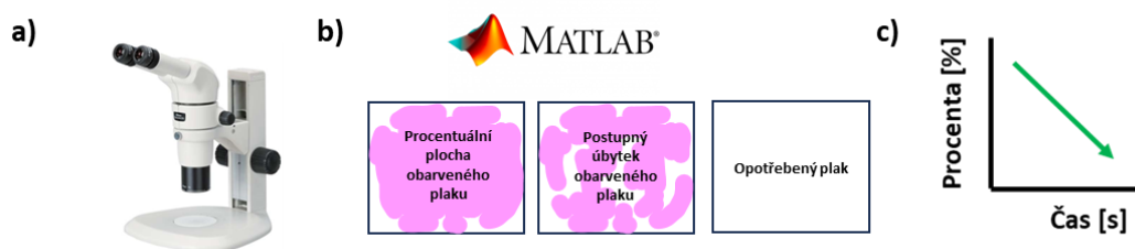
Obr. 4-24: Focení vzorku optickým mikroskopem (a), snímky po obrazové analýze v MATLABu (b), určení účinnosti čištění jako směrnice procentuálního úbytku plaku v čase (c)
