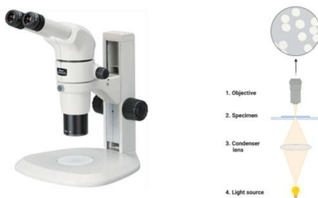
Obr. 4-7: Optický mikroskop Nikon, schéma principu optického mikroskopu [39]
