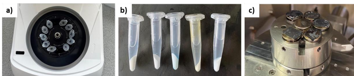
Obr. 4-12: Umístění vzorků v centrifuze MicroStar13 (a); vzorky zubních past ve zkumavkách po 2. centrifugaci (b): Elmex sensitive, Sensodyne EFRP, Colgate TW, Benjamínek, Weleda; vzorky na uhlíkových páskách pokryté zlatem (c)
