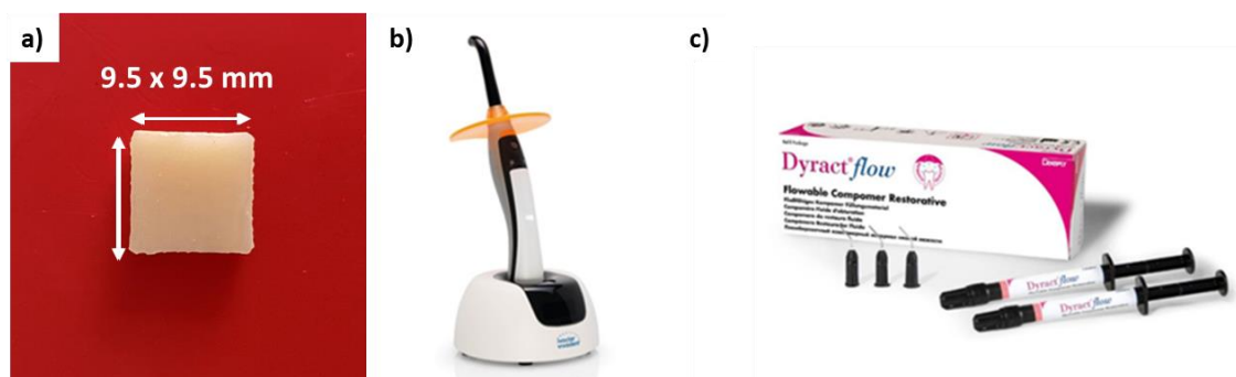
Obr. 4-8: Vzorek zubní výplně (a), UV lampa Ledex WL 090 (b), kompomerní materiál Dyract Flow Shade A2 (c) [40, 41]
