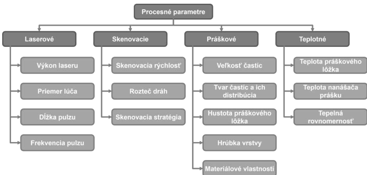
Obr. 2-2 Základné delenie procesných parametrov technológie L-PBF [5]
