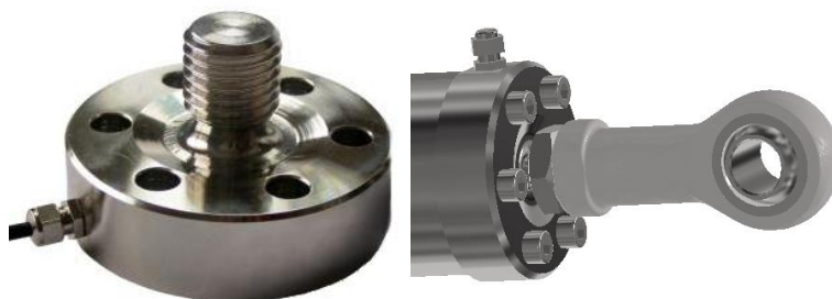
Obr. 6-16 Silomer Megatron MEG40 [21] (vľavo), model silomeru pripevnený k tlmiču s nasadenou kĺbovou hlavicom.
