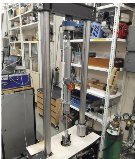
Obr. 6-19 Skonstruovaný MR tlmič počas testu na pulzátore.
