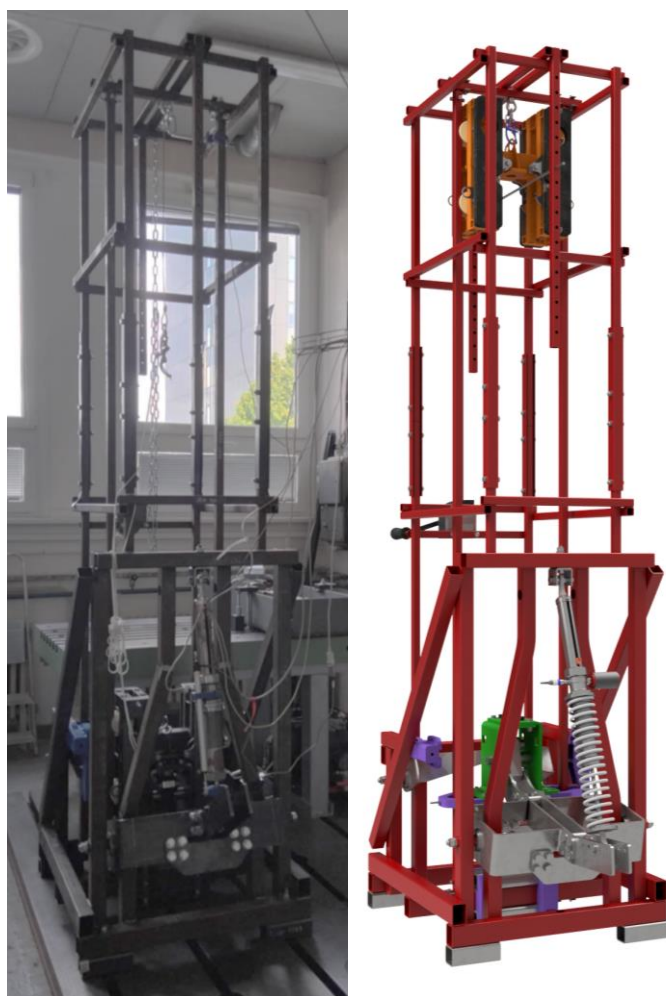
Obr. 6-21 Tlmič upnutý v pádovom testeri po dopade (vľavo), model testeru s tlmičom (vpravo).
