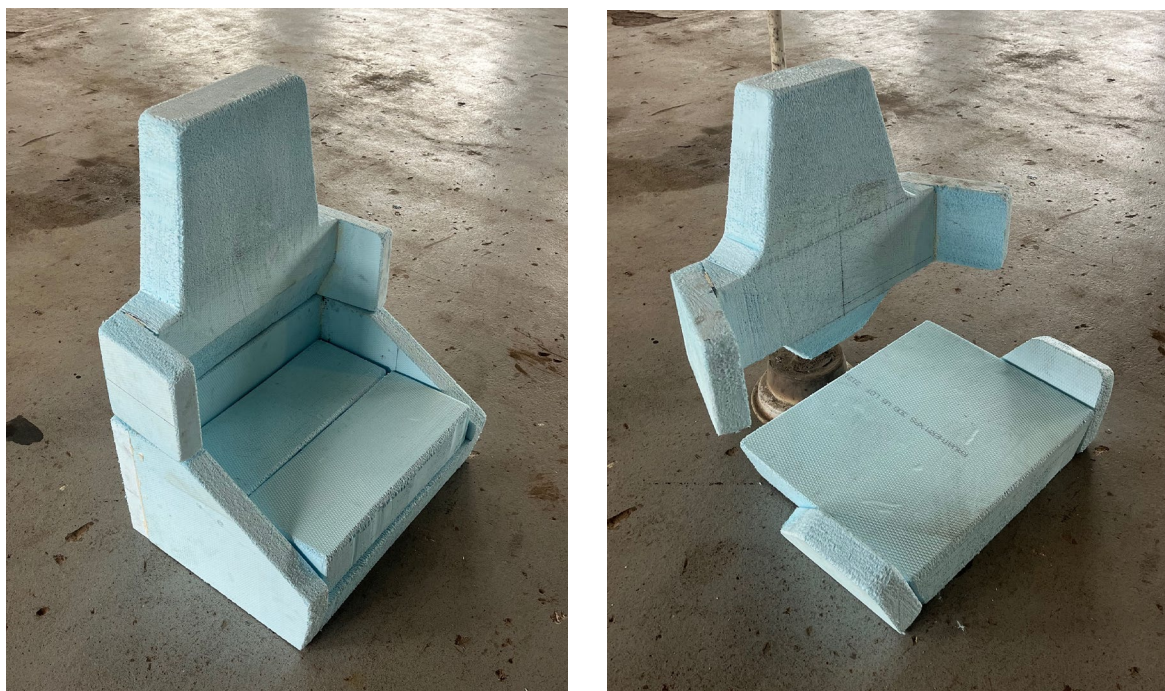
Obr. 5-3 Prototypní modely variant zádové opěrky
