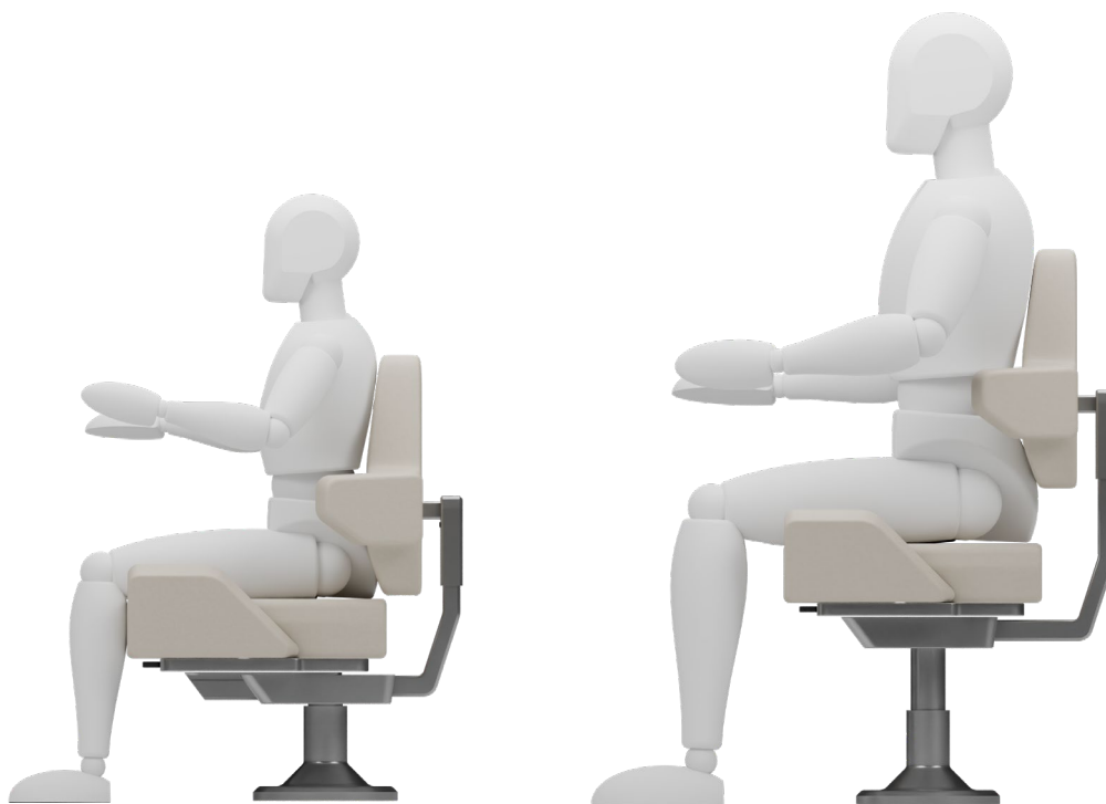
Obr. 6-8 Nastavitelnost sedačky pro sedící ženskou (5 percentil) a mužskou (95 percentil) postavu
