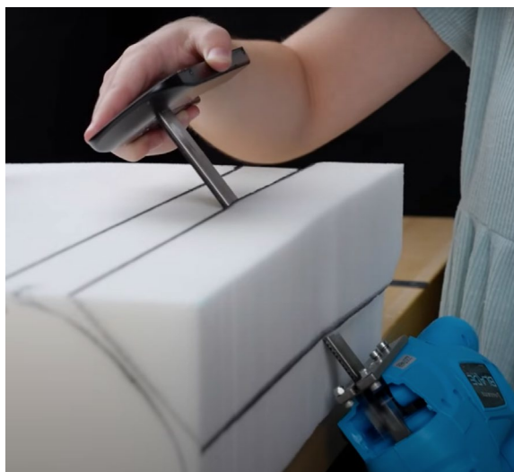
Obr. 2-37 Řezání polstrovací pěny [57]
