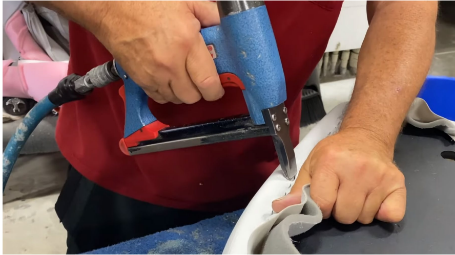
Obr. 2-39 Sponkování potahu k polyuretanové konstrukci [42]
