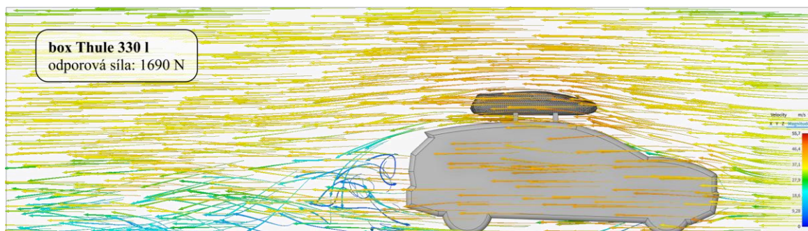
Obr. 4-10 Obrázek simulace odporu vzduchu boxu Thule.
