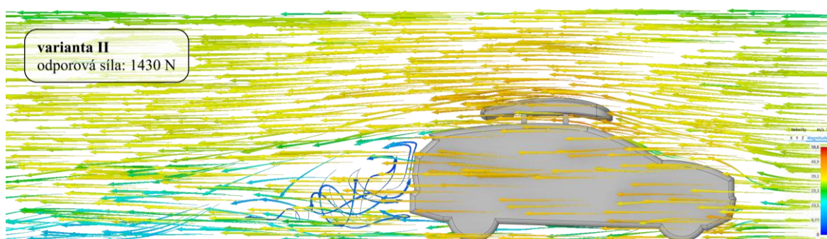
Obr. 4-11 Obrázek simulace odporu vzduchu druhé varianty.
