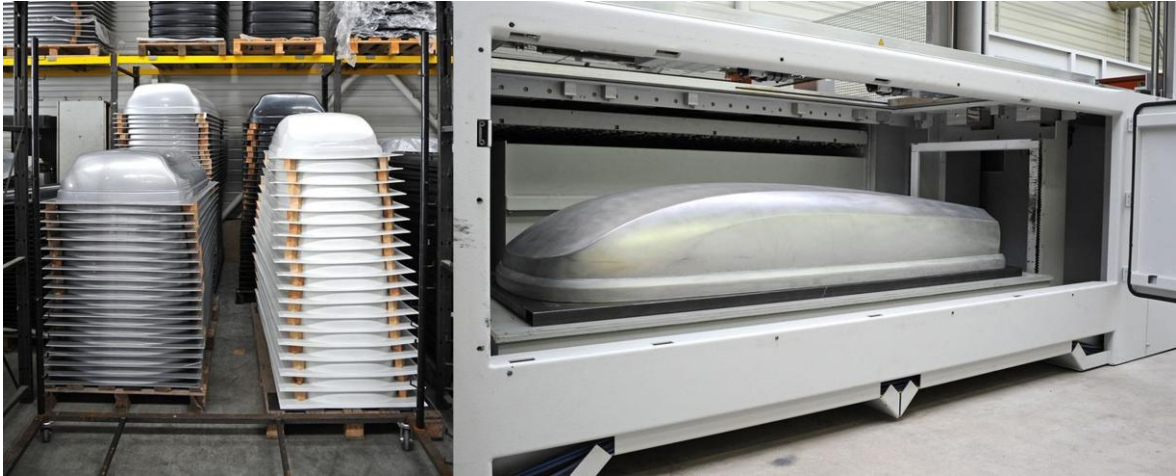
Obr. 3-5 Obrázek ukazující technologii výroby Termoforming. [23]
