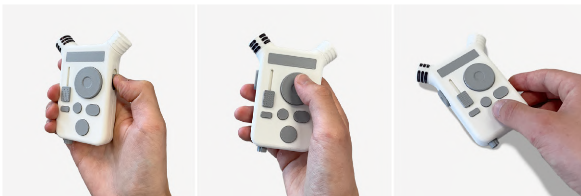
Obr. 6-9 zleva zapínání, přetáčení a spuštění nahrávky
