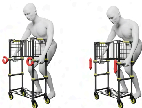
Princip změny výšky koše: povolení objímek otočením držadly → výškové nastavení → utažení otočením zpět
