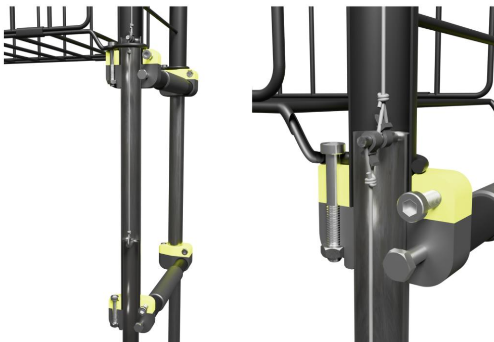
Obr. 6-4 Schéma pojistných mechanismů a přesahů trubek
