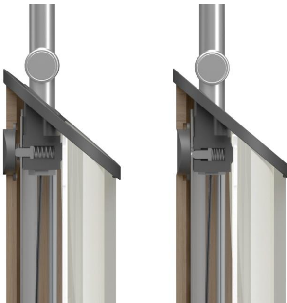
Obr. 6-6 Princíp ukotvenia nosného kusa
