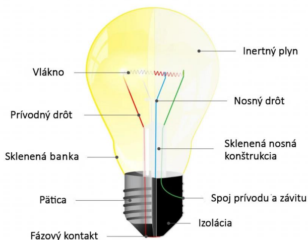
Obr. 2-12 Zloženie klasickej volfrámovej žiarovky (upravené) [24]
