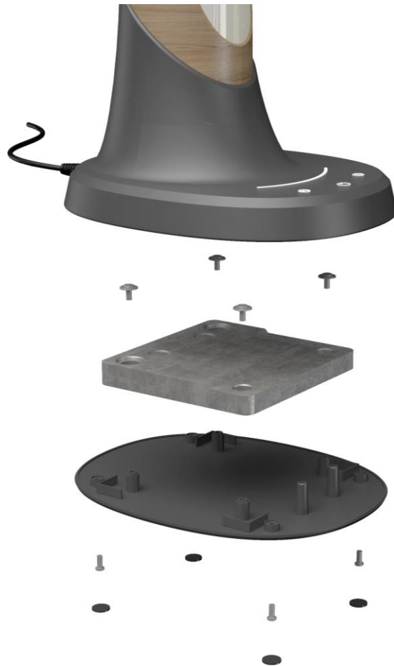
Obr. 6-7 Závažie a spodný kryt podstavca
