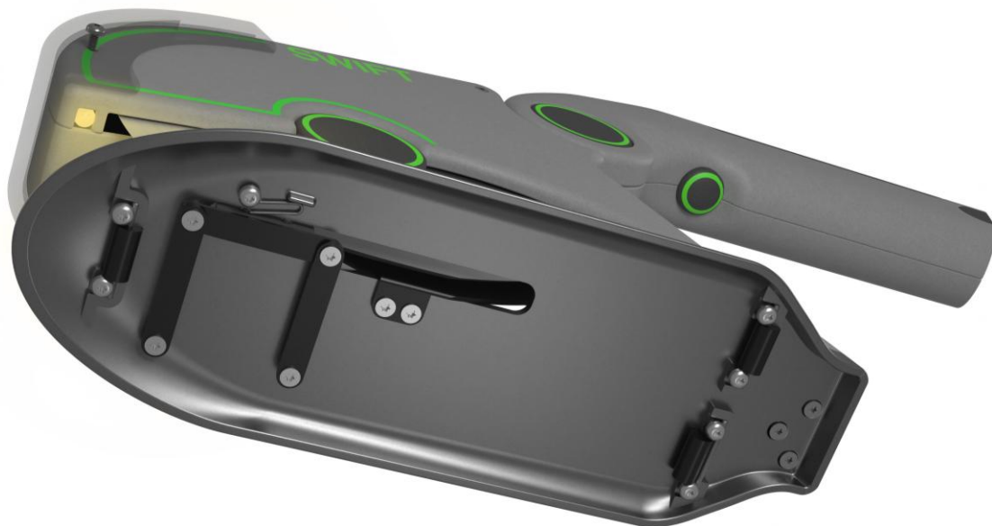
Obr. 6-14 Umístění osvětlení ze spodního pohledu na řezačku
