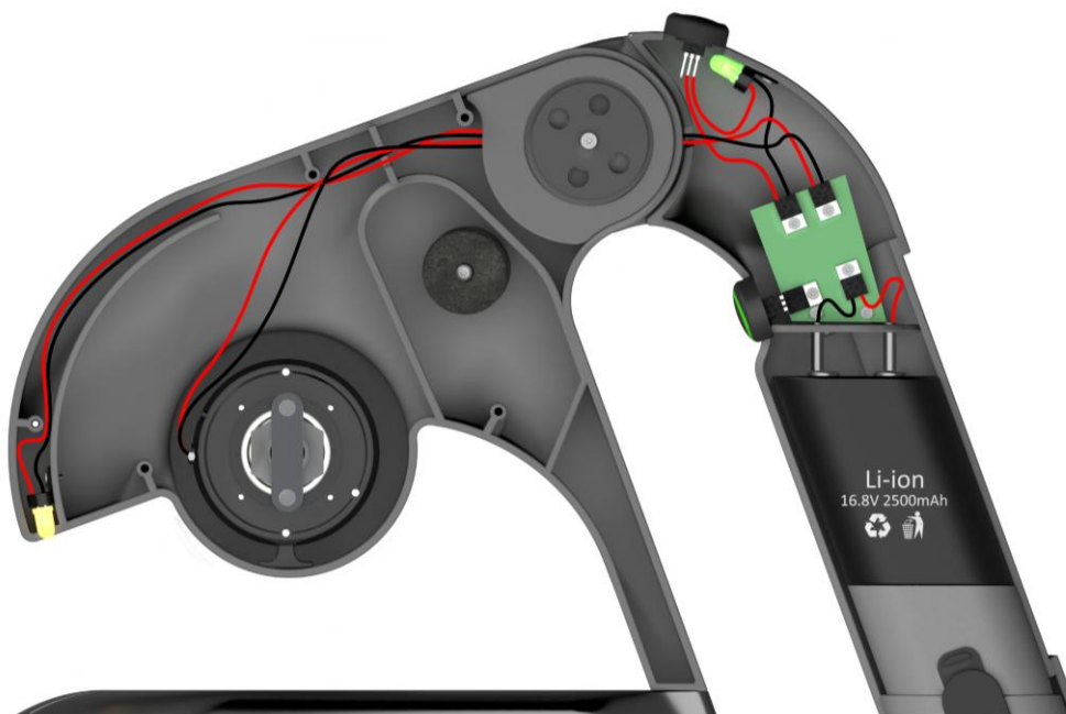
Obr. 6-4 Schéma elektrického zapojení součástek
