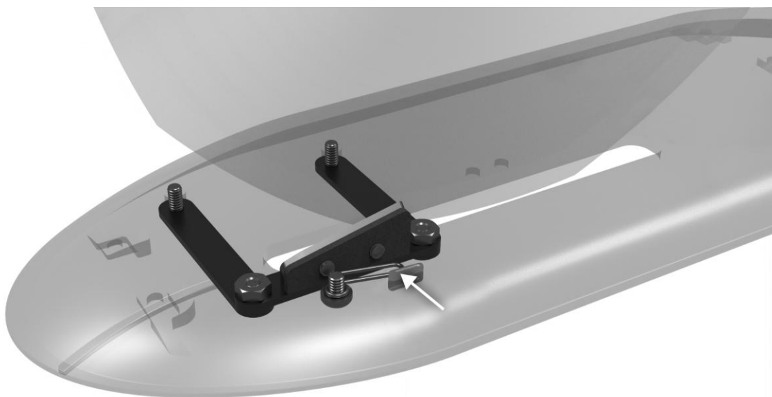
Obr. 6-6 Mechanismus zajišťující přitlak mnohoúhelníkového nože s protiostrím
