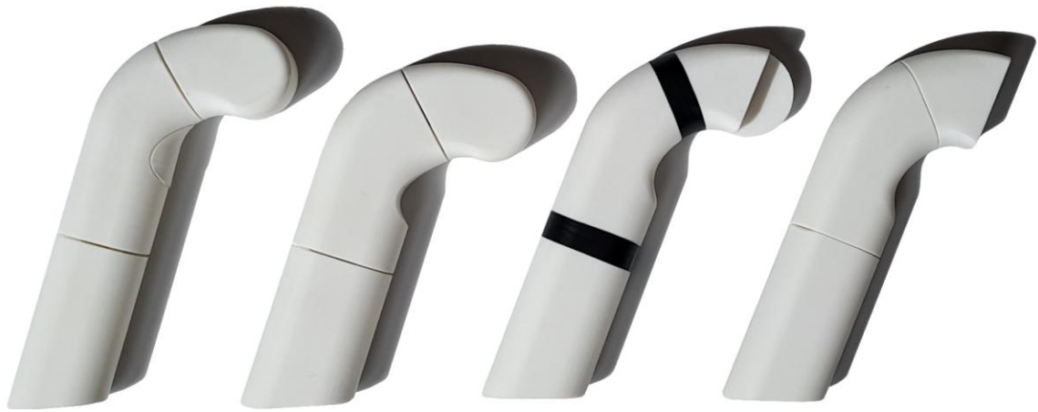
Obr. 5-2 Studie tvaru rukojeti, 3D tisk, PLA
