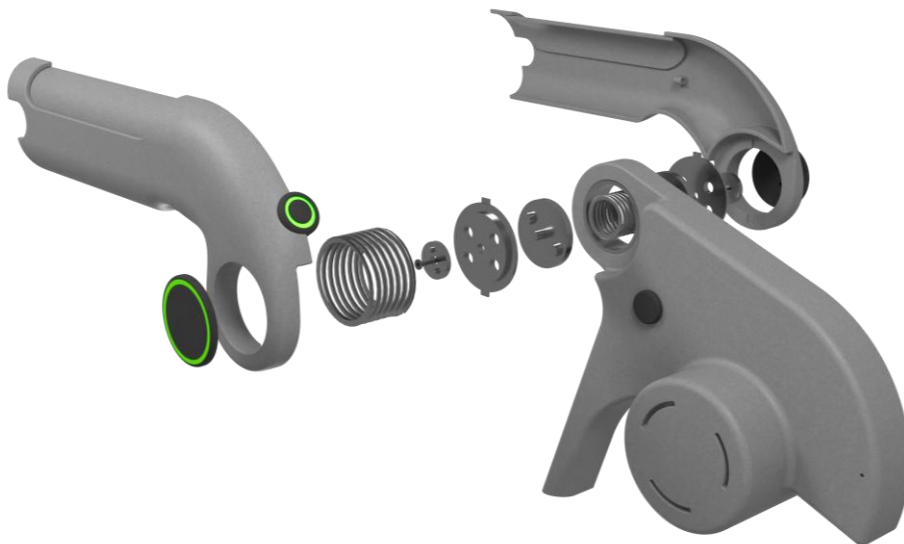
Obr. 6-12 Mechanismus aretace polohy rukojeti
