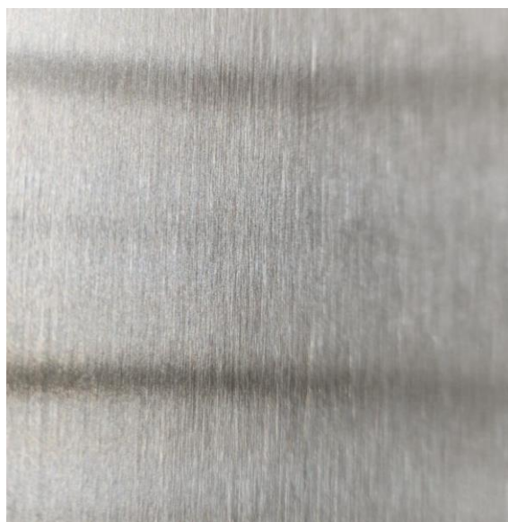
Obrázek 36 - Detailní pohled na ocel po kartáčování [29]
