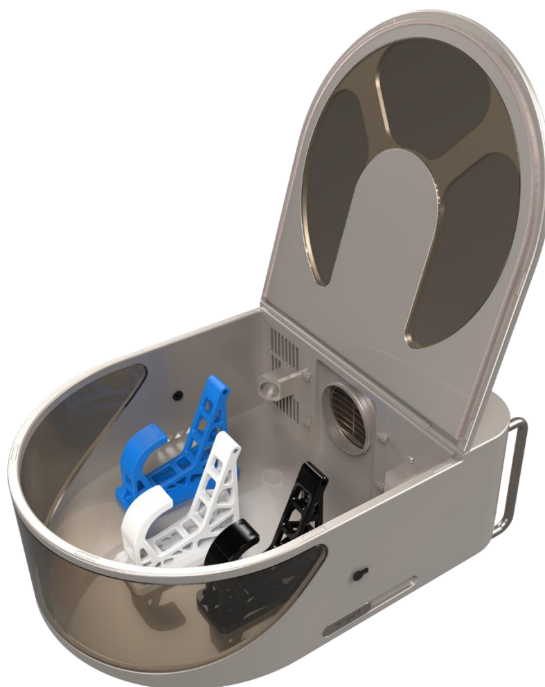
Obr. 5-13 Režim žihání – sušení hotových výtisků.
