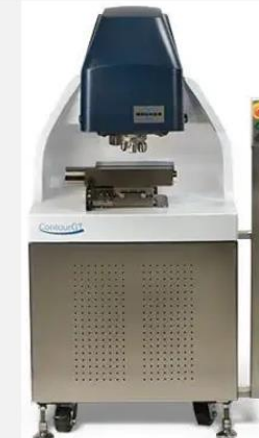
Optický profilometr Bruker ContourGT-X
